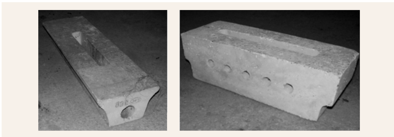
Obrázok 41: Pôvodná tvarovka dýzy (vľavo) a nová tvarovka splyňovacieho kotla (vpravo) (20)
